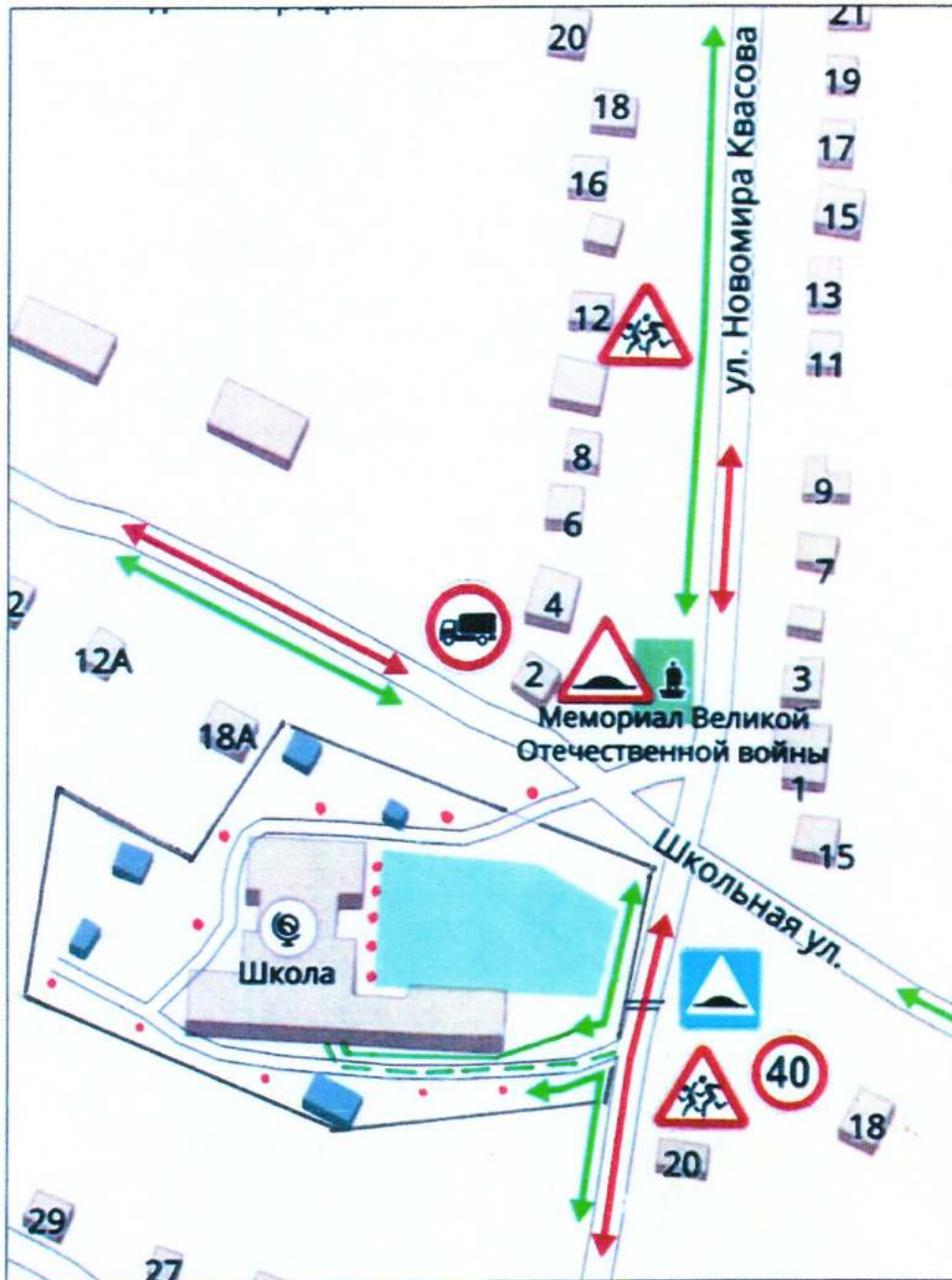
2.Схема организации дорожного движения в непосредственной близости от образовательной организации размещением соответствующих технических средств, маршруты движения детей и расположение парковочных мест
